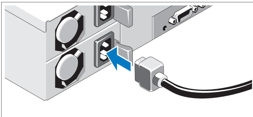
将系统电源电缆连接至系统，如果使用显示器，则将显示器电源电缆连接至显示器。将电源电缆的另一端插入接地的电源插座或单独的电源，如不间断电源设备 (UPS) 或配电装置 (PDU)。
